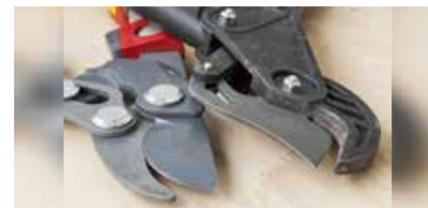
Links arbeiten zwei Schneiden (Bypass-Technik). Rechts trifft die Klinge auf einen Amboss (Amoss-Schere)
